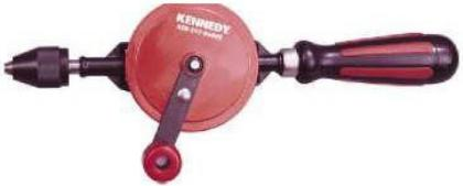
Vrtáčka se dvěma pastorky má tělo vyrobené tlakovým litím a šroubovací skličidlo se třemi čelistmi. Plastová rukojeť s plastovými dráždly a šroubovacím horním dílem pro uskladnění vrtáků. Pro drobné vrtací práce.
